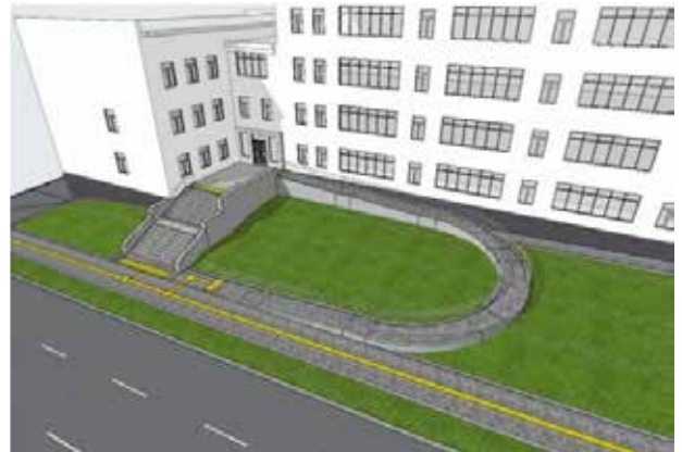
Рис. 2, 3. Планувальне рішення та тривимірна модель планувального рішення пандуса
