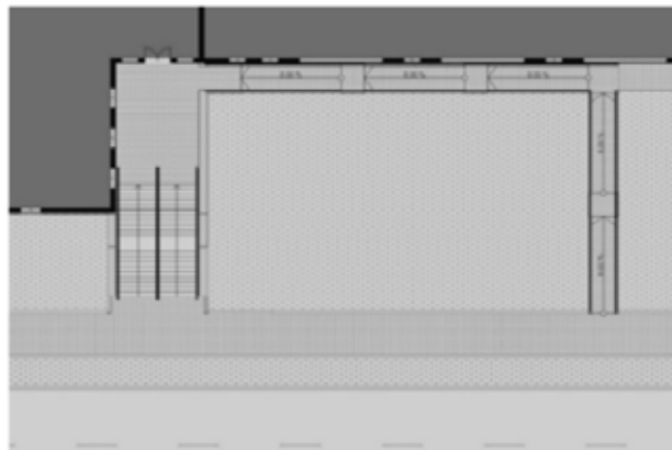
Рис. 6, 7. Планувальне рішення та тривимірна модель планувального рішення пандуса
