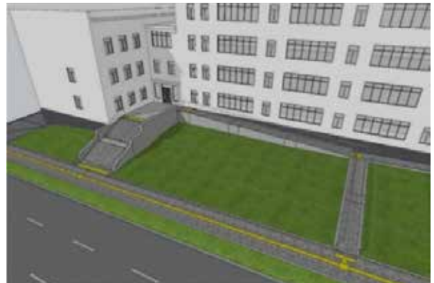
Рис. 6, 7. Планувальне рішення та тривимірна модель планувального рішення пандуса
