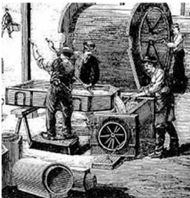
Рис. 2. Виготовлення блоків із романцементу у Франції XIX ст. Джерело https://hal.science/hal-01872660v1/document
