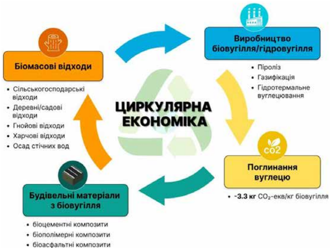
Рис. 2. Схема виробництва та застосування біовугілля
