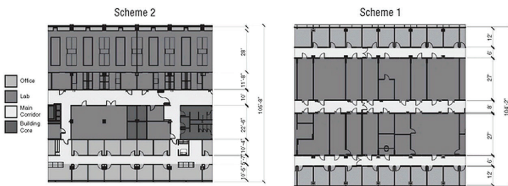
Рис. 10. Рекомендовані схеми зонування лабораторних приміщень [24].
