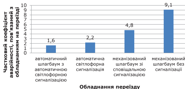
Рис. 2. Залежність часткового коефіцієнта аварійності від обладнання охороняемого переїзду
