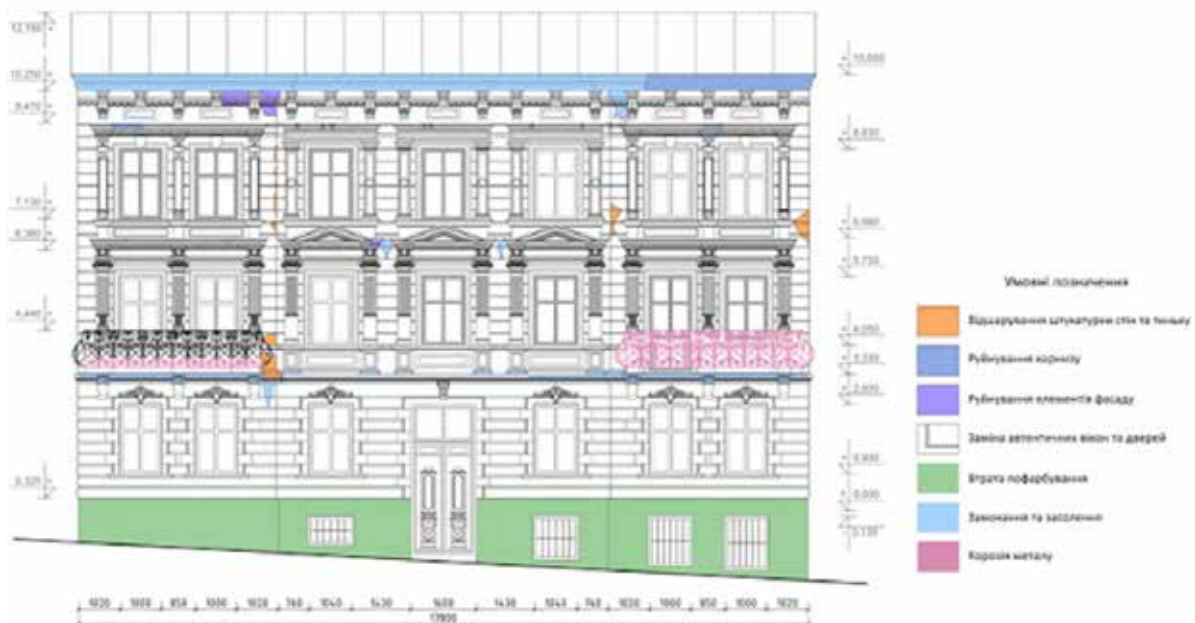
Рис. 3. Картограма втрат, дефектів та пошкоджень фасаду
