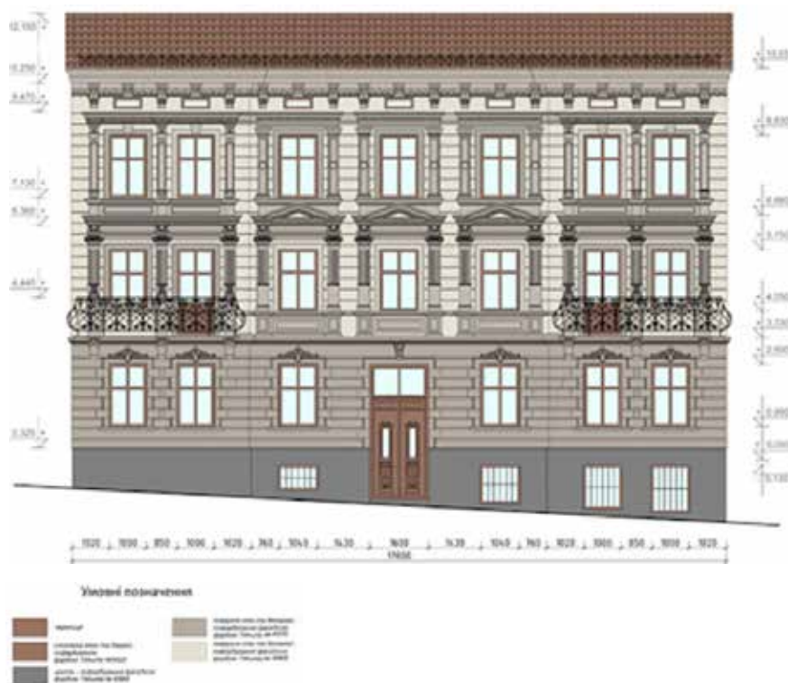
Рис. 4. Паспорт опорядження фасадів
