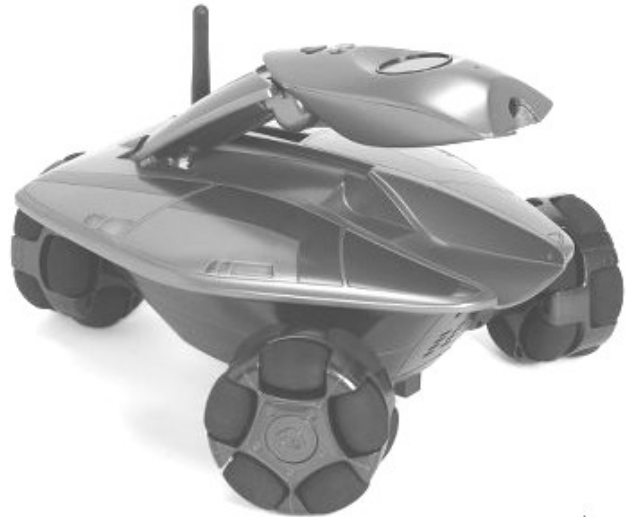
Рис. 2 – Самохідна вебкамера робот Rovio – розробка Гонконгської компанії WowWee
