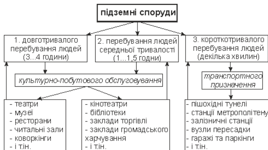
Рис. 2. Класифікація підземних споруд за тривалістю перебування
