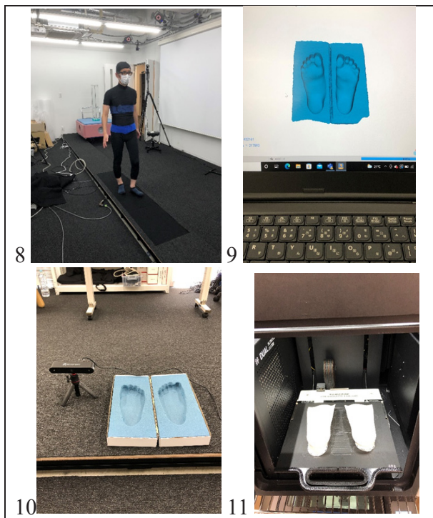
Рис. 8. Аналіз руху людини. Рис. 9. Моделювання форми. Рис. 10. Сканування відтиску стопи. Рис. 11. Процес друку устілок
