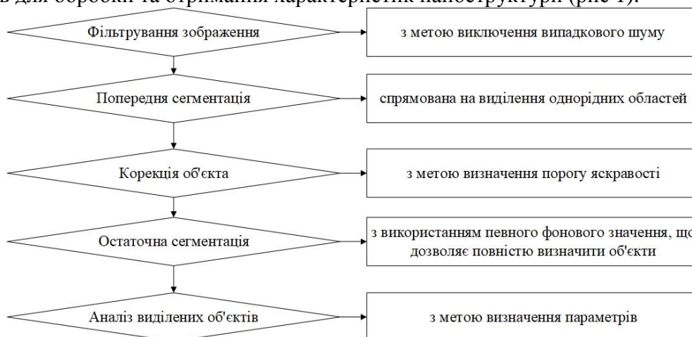
Рис. 1. Послідовність алгоритмів для обробки зображень, отриманих за допомогою мікроскопів
