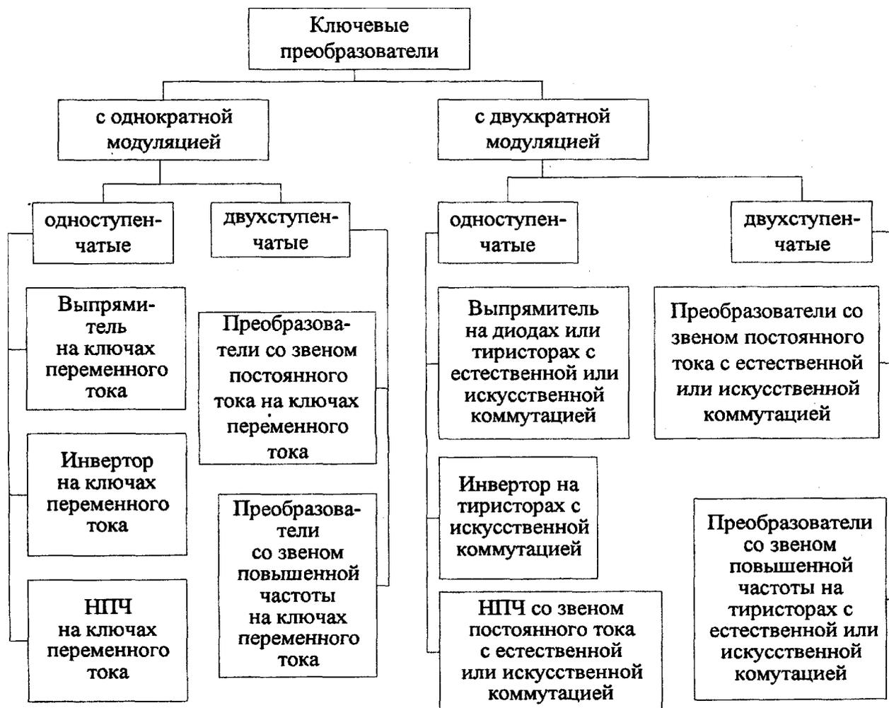
Рис.1. Классификация вентильных преобразователей
