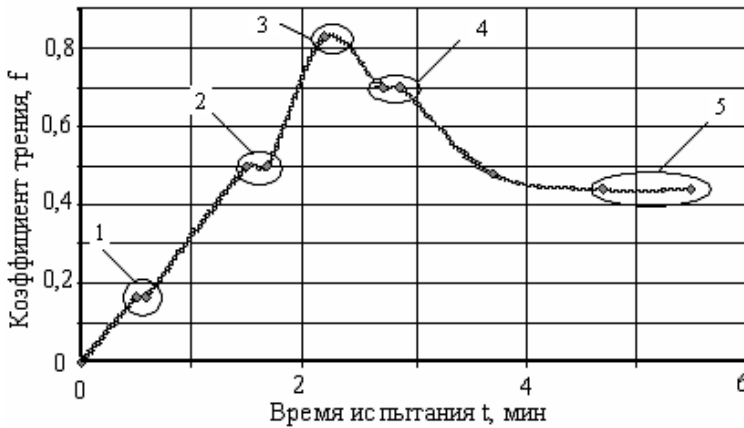
Рис. 2. Изменение коэффициента трения при изнашивании структур поверхностных слоев роликов: (1-5) – участки нормализации процесса трения
