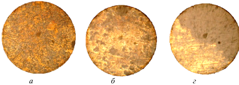
Рис. 1. Структура вихідного СКАМ Cu-Sn-P-MoS_2 (а) і вторинних змащувальних плївок, сформованих на його поверхні при терті у вакуумі (в структурі вони сірого кольору) за швидкості ковзання 1 м/с при тисках 2,5 МПа (а) і 5 МПа (б); \times 300
