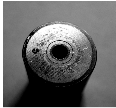
Рис. 15. Торцевая поверхность ползуна с запрессованной втулкой из стали ХВГ после 100000 циклов срабатывания клапана
