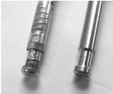
Рис. 6. Износ поверхностей штока в процессе отработки ресурса
