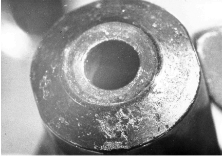
Рис. 2. Повреждения верхней торцевой поверхности ползуна (якоря) под действием циклических ударных нагрузок во время открытия клапана (формоизменение поверхности контакта со стопорной шайбой и выкрашивание поверхности по месту контакта с верхним стопом)
