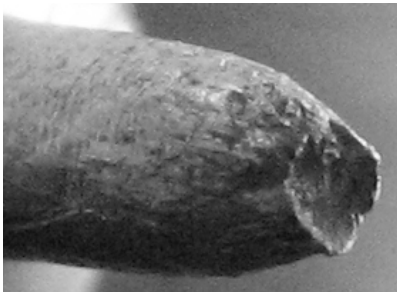
Рис. 10. Усталостные изломы стержневых элементов ЭМК с приводом типа ДТВ: а – материал VT5-1; б – материал АК4-1; в – материал VT1-0
