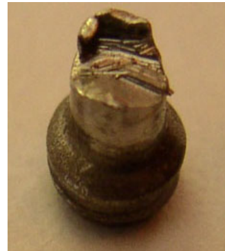
Рис. 7. Усталостное разрушение шейки штока
