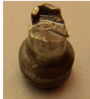
Рис. 5. Руйнування шийки штока від втоми (матеріал – сталь 08X18H10)
