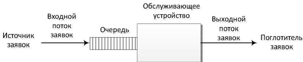
Рис. 1. Структура системы массового обслуживания
