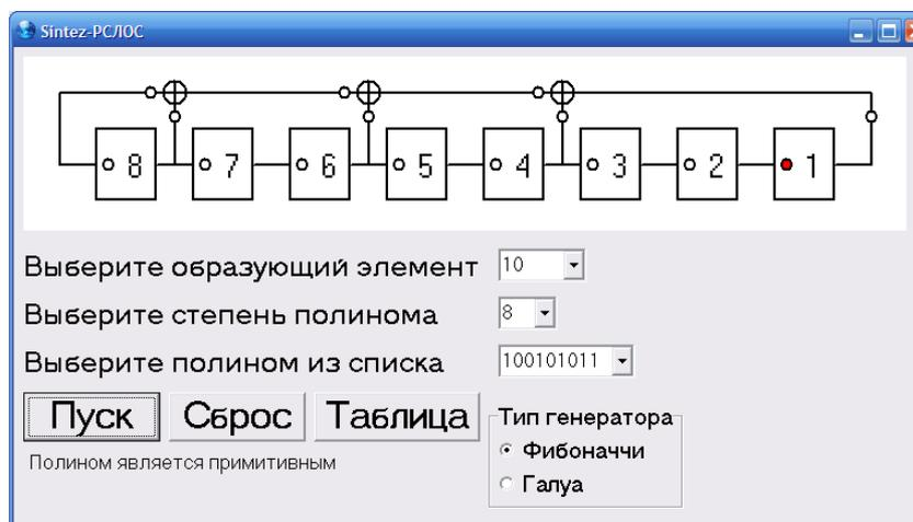
Рис. 4. Построение регистра сдвига с линейной обратной связью
