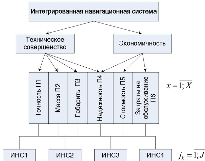
Рис. 2. Структурная схема связей показателей при выборе комплектующих ИНС
