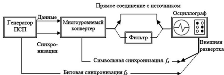
Рис. 1. Построение глазковой диаграммы: ПСП – псевдослучайная последовательность
